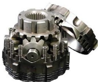
ケース開口部拡大によりオイル循環が強化され、発熱による特性変化を低減。そして、クラッチプレートの内ツメ寸法が勤合深さを増し、強度アップが図られ急激な接続にも破損しづらく耐久性が向上し、またオイル循環のための形状に変更済み。これは攪拌されたデフオイルがクラッチプレート間に入りこみやすくし制限トルクを緻密に伝達している。
